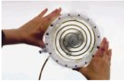
Wärmeapplikator für die lokale Oberflächenhyperthermie. Die spiralförmige Antenne strahlt Mikrowellen aus.
